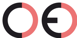
Faux marquage CE (trop éloignée)
